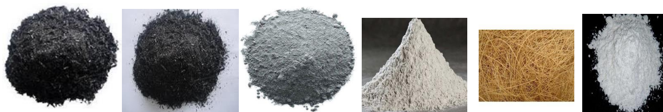
(a)Rice Husk Ash (b) Sugarcane Bagasse Ash (SCBA) (c) Fly Ash (d) GGBS (e) Natural fibers (f) Hydrated Lime
